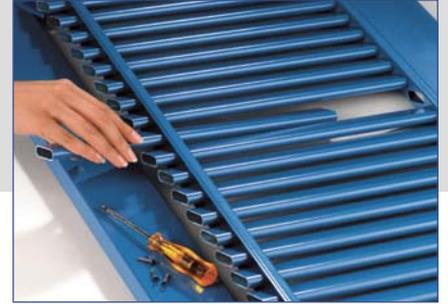
Durch das Klemmprofil lassen sich Lamellen bei Beschädigung problemlos austauschen. Sie sind schallgedämpft gelagert und geben keine Schwingungen an das Rahmenprofil weiter.
