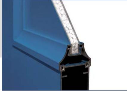
Die schallgedämpfte Füllung besteht aus 2 Tafeln aus Aluminium mit einer speziellen Dämmschicht in Sandwich-Bauweise.
