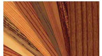
Ein patentiertes Verfahren ermöglicht eine Beschichtung, die von der original Holzstruktur kaum zu unterscheiden ist. Auf ein aufgebracht Grundpulver erfolgt in einem zweiten Einbrennvorgang das gewünschte Holzdekor. Die Qualität dieser Beschichtung übertrifft dabei in punkto Restglanz, Farbtonstabilität und Oberflächenhärte, die einer normalen Pulverbeschichtung.
